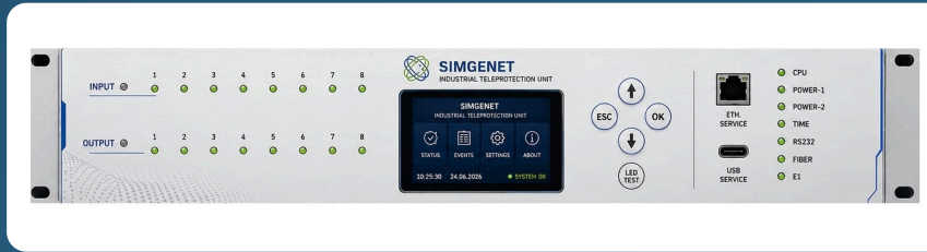
SMG50 ön panel · 8 giriş / 8 çıkış LED, dokunmatik durum ekranı, servis portları, link göstergeleri
